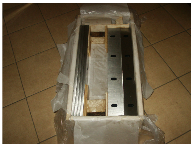
Nože do drtiče v CHD na zpracování plastů
